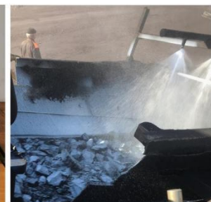
Рис. Общий вид обработки угля раствором на конвейере
