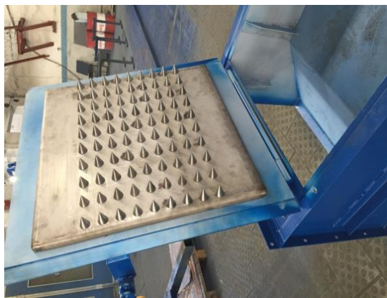
Иллюстрация некоторых из разработанных магнитных сепараторов (разных конструкций), внедренных на предприятиях пищевой отрасли страны
